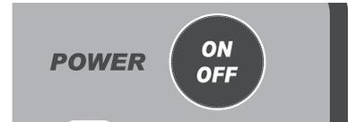
1. Lorsque le four est à l'arrêt, appuyez longuement sur la flèche VERS LE HAUT située dans la section STEPS (étapes). Tout en appuyant sur la flèche VERS LE HAUT, appuyez longuement sur le bouton POWER ON/OFF (marche/arrêt) pendant 3 secondes. Lorsque tous les affichages s'allument, le four est en mode recette.
